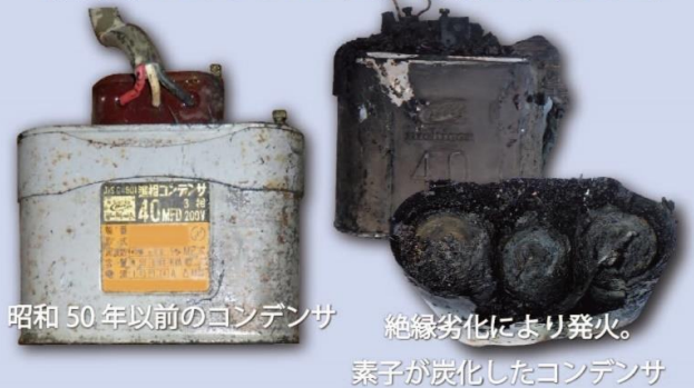
金属を溶かすほど発熱した部分
