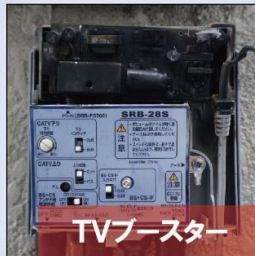
侵入した電流により焼損した機器
